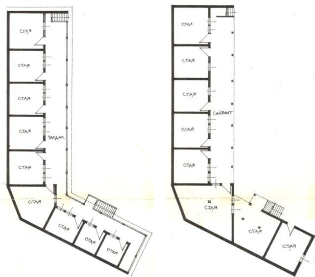
Фиг. 26 Хан – разпределение на първо и второ ниво. Извадка от досие на НКЦ, „Къща на Никола Бараков-Цънцаров хан“, ПД-605-4-I, деклариран с писмо от 1987 г.
